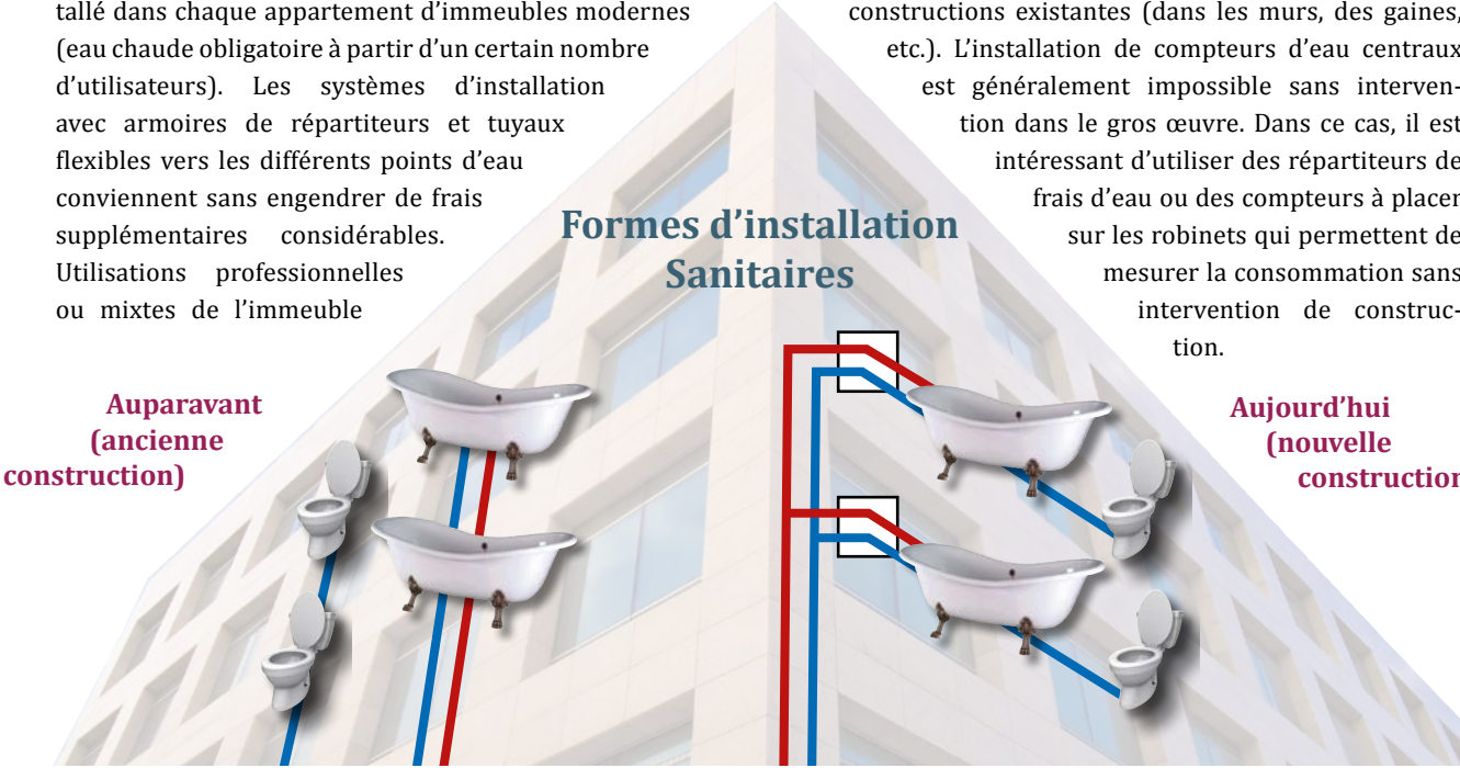
Comparaison du système d'installation fondamental auparavant (c'est-à-dire avant 1990 env.) et aujourd'hui.
